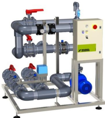
**DrenaMix** è progettato per essere installato direttamente a lato della relativa unità di dosaggio i cui attacchi di ingresso/uscita sono già predisposti su DrenaMix nella giusta posizione. **DrenaMix** ha già a bordo una valvola di **bypass** e una di **non-ritorno** per poter irrigare direttamente le coltivazioni in un eventuale momento di fuori servizio dell'unità di dosaggio.
