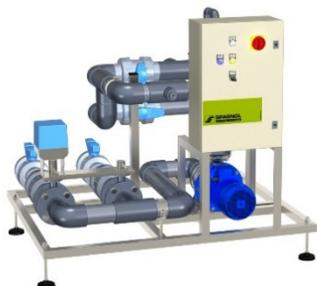
La miscelazione delle due acque in ingresso viene gestita in base da una EC di uscita desiderata (programmata su unità di dosaggio o controller a bordo). Come opzione, installando un sensore di flusso su entrambi gli ingressi, è possibile eseguire la miscelazione a percentuale (il valore di EC viene monitorato per eventuale allarme).
